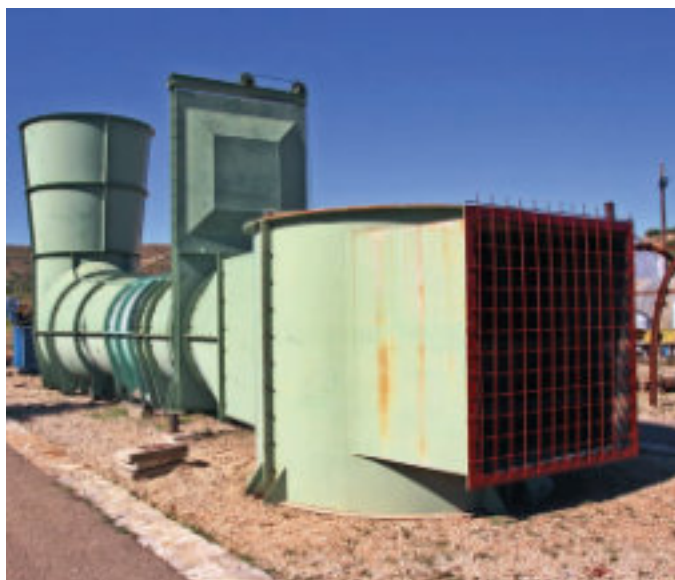
Este ventilador es uno de los nuevos elementos expuestos en el museo minero. Su misión era extraer el aire viciado de la mina.
