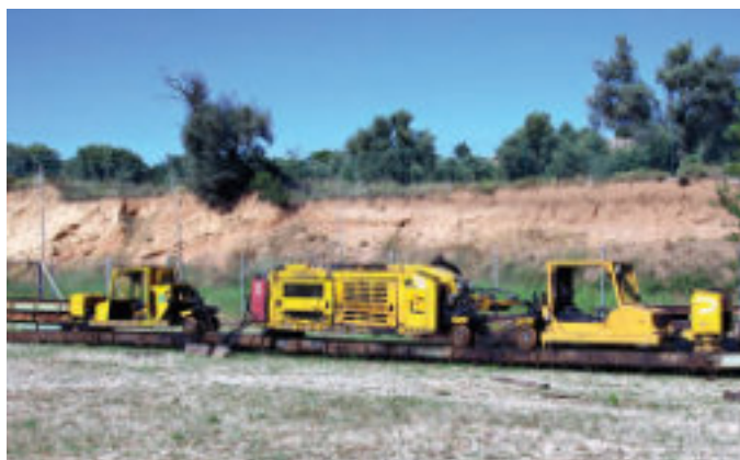
Esta locomotora de dos cabinas se utilizaba para transportar materiales y personas en el interior de la mina. Está todavía pendiente de restauración.
