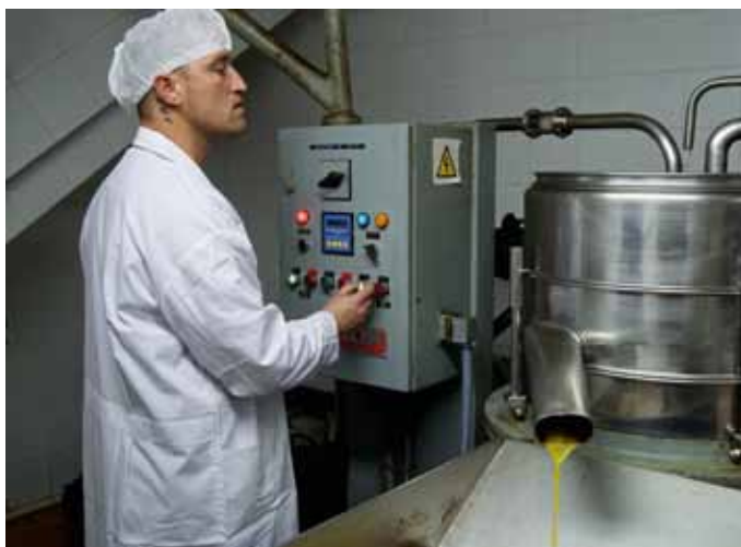
Poniendo en marcha una de las centrifugadoras
