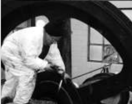
Un instante del desmontaje del eje principal.
