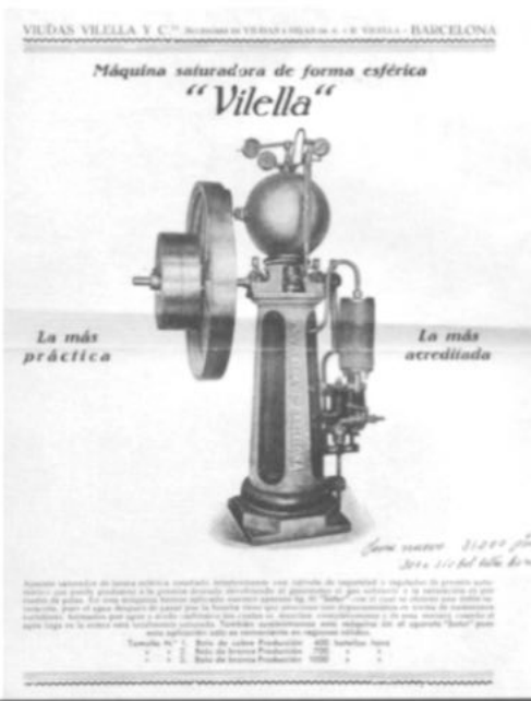
Máquina saturadora ofrecida a La Andorrana «semi nueva» por 31.000 pts., que rellenaba de 300 a 500 botellas diarias.
